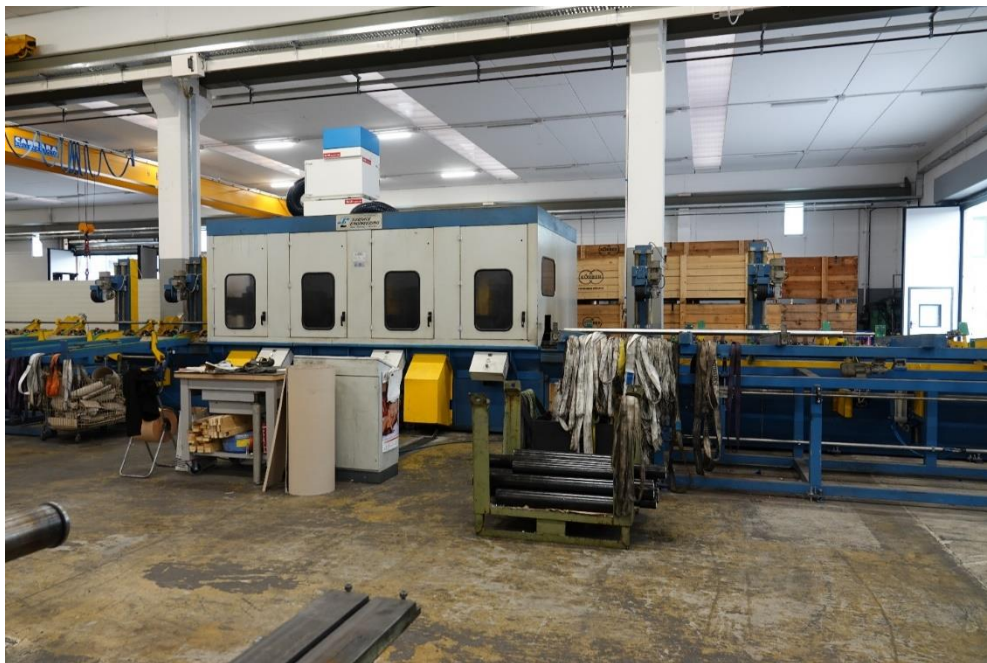
Lucidatura centerless fino a \varnothing 220 e con centri fino a \varnothing 1000
